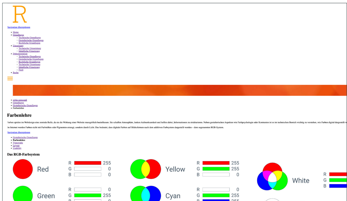
Bild 8: Website ohne CSS-Styling – die Seite zeigt lediglich die reine HTML-Struktur ohne Layout, Farben oder Formatierungen. Dadurch wird deutlich, dass Inhalte zwar vorhanden sind, aber ohne visuelle Gestaltung unübersichtlich wirken. 13
