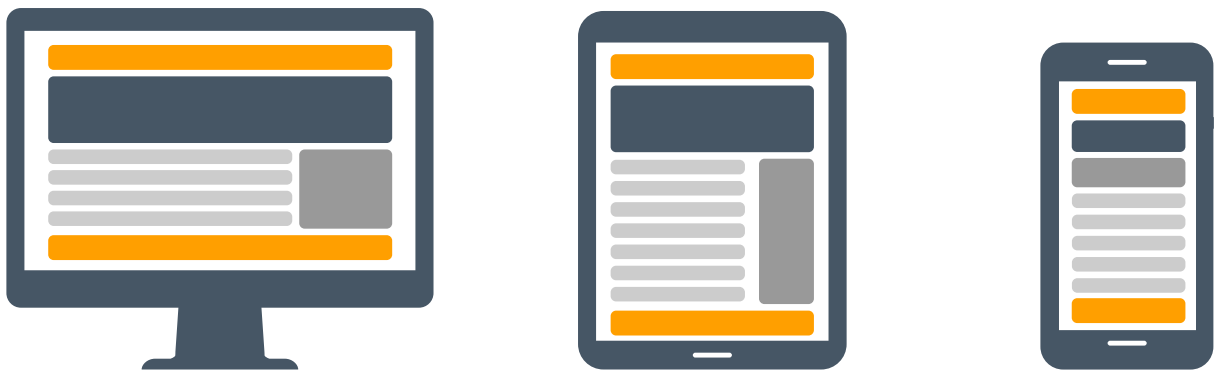
Bild 4: Beispiel des responsiven Webdesigns auf Desktop, Tablet und Smartphone. Der obere orange Balken steht für den Header, der untere für den Footer, während der mittlere Bereich den Inhaltsbereich (Content) visualisiert.
